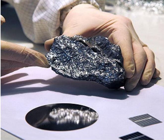
O silício metalúrgico, a lâmina (centro) e as células solares (à dir.)
